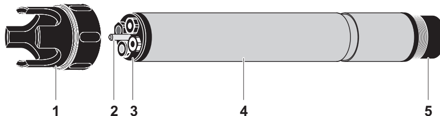
Figura 1-2 Estructura del sensor VARiON ® Plus 700 IQ
